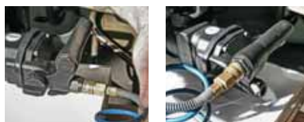
Zuluftführung wahlweise nach hinten oder nach unten
