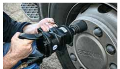
Zuluftführung wahlweise nach hinten oder nach unten
